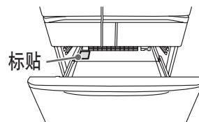
安装下层抽屉时，请将下层抽屉左右突出的部分向门框两旁的洞插入固定。
