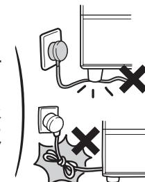
在已受损的状态下使用时，会有引起触电、短路、火灾的危险。
