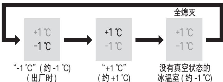
\* 周围温度30 °C没有放入食物，冰箱门关闭的状态，在稳定时的休眠保鲜真空冰温(便利功能区)的大致温度。
