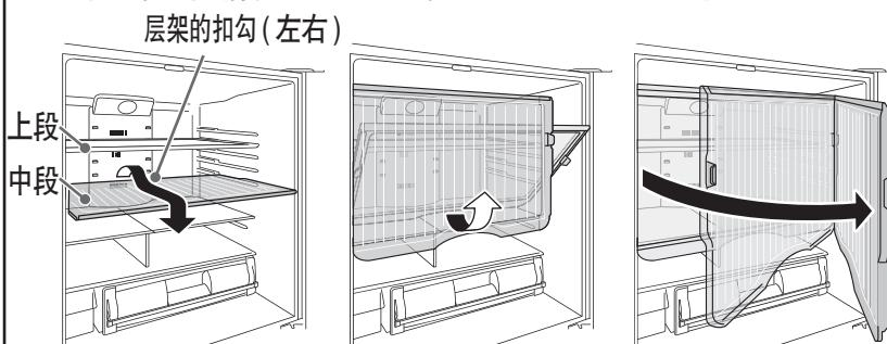
安装时,把层架插放到最内侧之后,把层架内侧稍微抬高并推进去。
