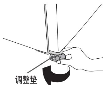
● 过度旋转调节脚，可能导致调节脚脱落。
