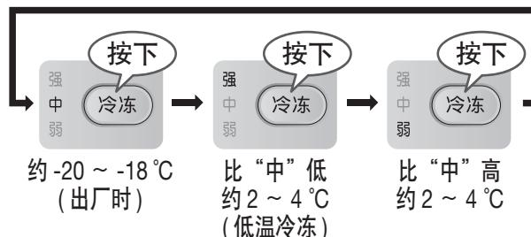
※是在冰箱的环境温度 约 30 °C、冷藏室和冷冻室都设定为“中”、没有放入食物且关闭冰箱门的状态下的大致稳定温度。
