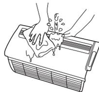
**注意** 开始清洗以前请停止机器运行，并拔掉电源插头。
