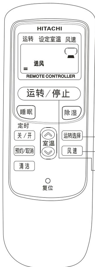
本机也可作空气循环机使用，在夏天末期可利用此功能使空调器的内部干燥。
