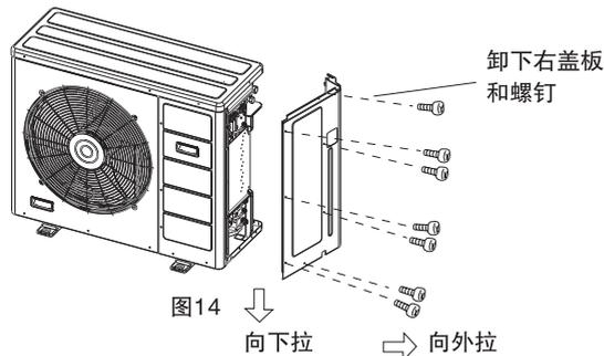
注意：当固定“右盖板”的7处螺钉拆下后，“右盖板”易按右图箭头方向，向下滑落。安装时请特别注意，防其从高空坠落，造成人员伤亡。
