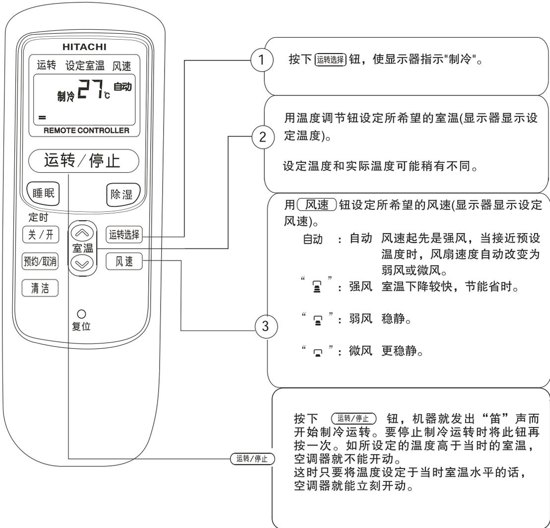
■各项设定状态全被储存于遥控器中，所以下次操作机器时只要按下 **运转/停止** 钮即可。
