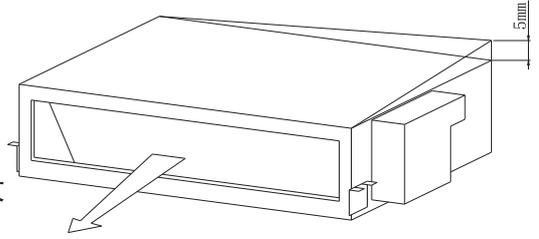
图7 顶面倾斜度
