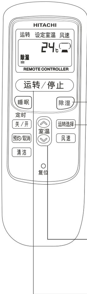
1 按下(除湿)钮, 机器就发出“笛”声而开始除湿工作。这时风速自动被设定于微风“☁️”, 风速钮不起作用。
