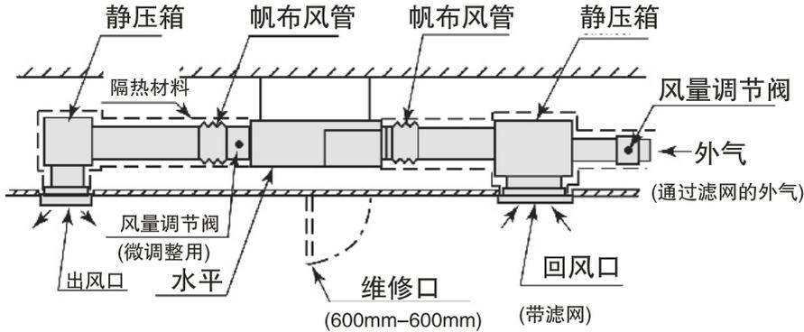
图8 风管的连接
