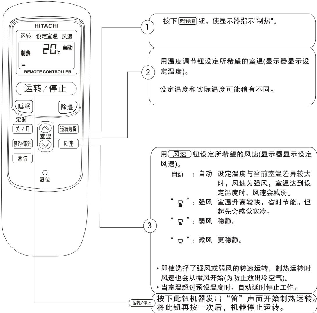
■ 各项设定状态全被储存于遥控器中，所以下次操作机器时只要按下 **运转/停止** 钮即可。
