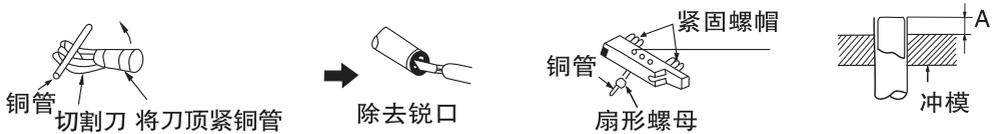
用扩口工具把管端扩成扇形, 应注意扇形螺母已塞进铜管。
