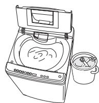
**3** 再将进水管接至水龙头，检查洗衣机是否正常进行进水、排水动作。
