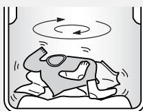
波轮及洗涤·脱水筒在无水状态下旋转，检测洗涤量。
